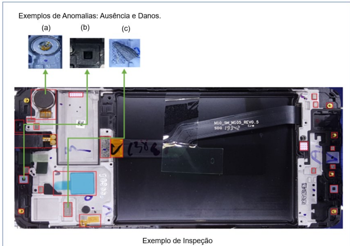
Figura 1 - Exemplos de itens inspecionados e anomalias. (a) e (b) componentes ausentes, (c) componente danificado.
