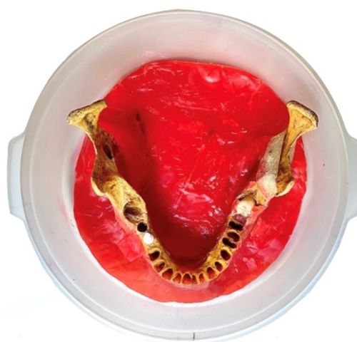
Figura 2- Vista superior do fantoma: mandíbula humana posicionada no interior do container de plástico e fixada com auxílio de cera de utilidade, e implante de zircônia posicionado na região do dente 46.
