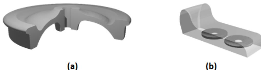
Figura 3.5 - Em (a), desenho esquemático de uma roda ferroviária. Em (b), apresenta-se a região de retirada dos discos no aro da roda. Fonte: Autor.
