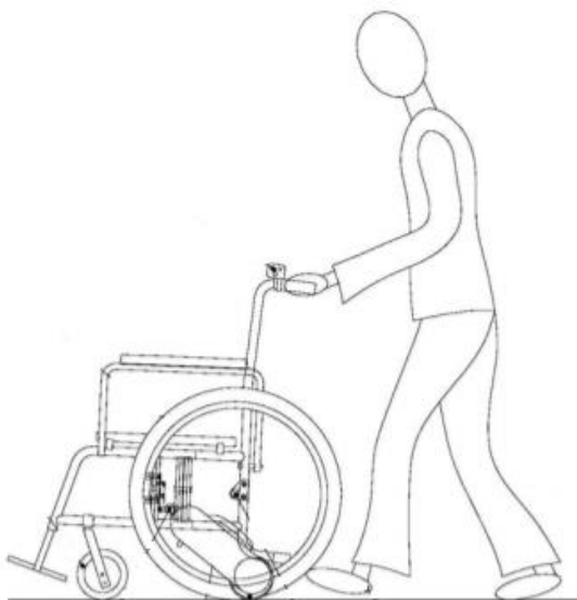
Figura 2.41 –Representação do conjunto motorizado da patente “Assistive driving system for a wheelchair” com a configuração em RC. Adaptado (Yincong e Tianjiao, 2020).
