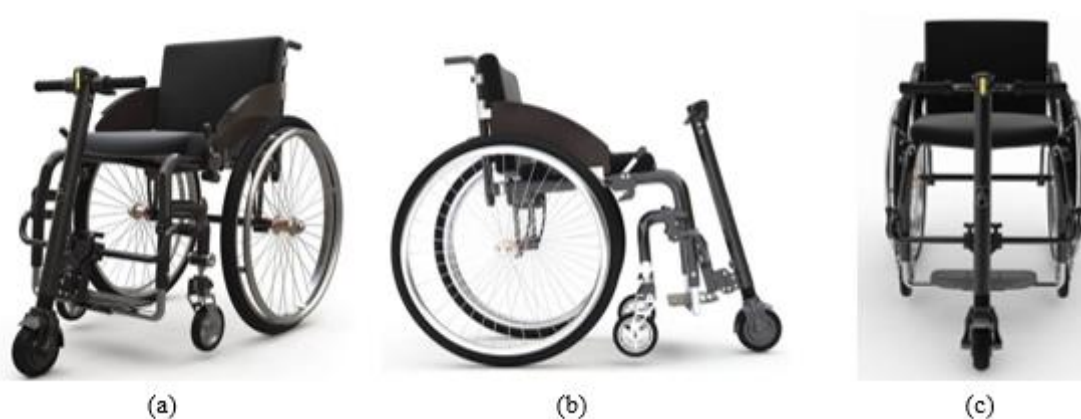
Figura 2.24 – Módulo “UNAwheel Mini”. (a) Representação em perspectiva, (b) Vista lateral, (c) Vista Frontal. (“SYNC Living”, 2021).
