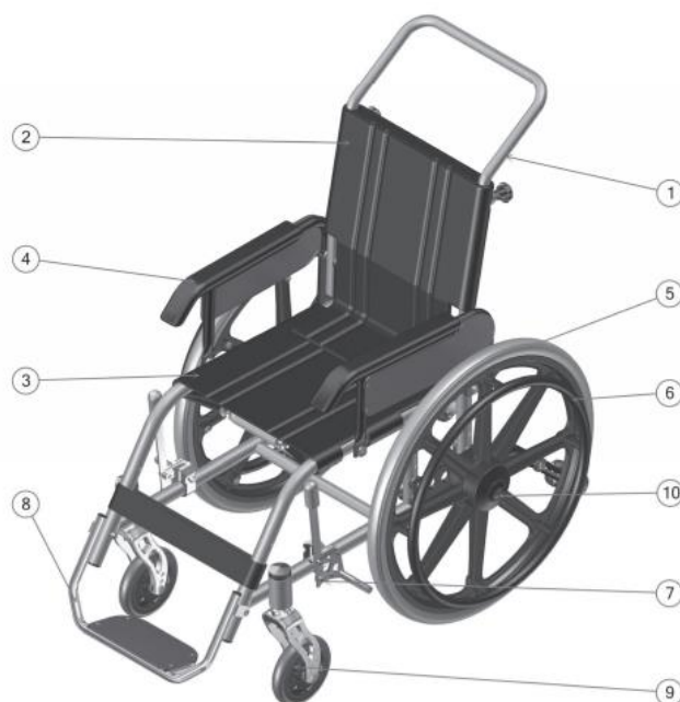
Figura 2.3 – Componentes principais de uma cadeira de rodas manual. (Ortobras, 2008).
