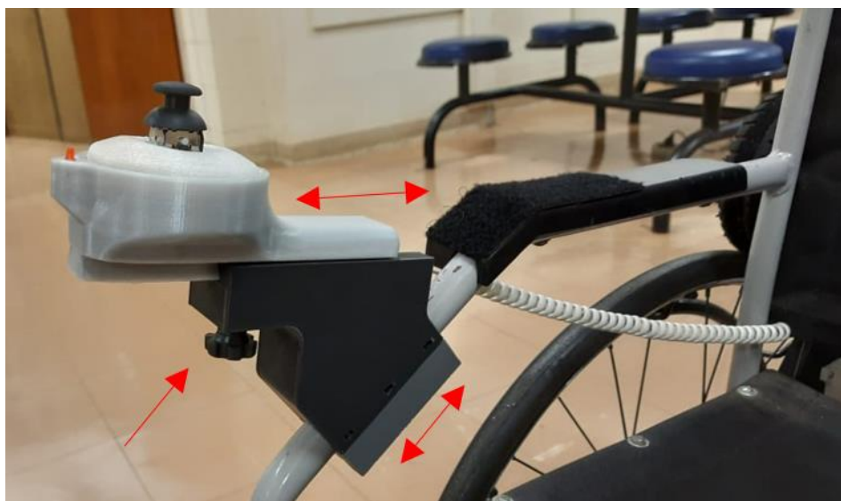
Figura 7.3 – Dispositivo de controle da cadeira de rodas por Joystick .
