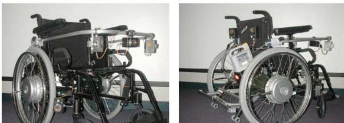
Figura 2.48 – Representação em perspectiva do protótipo da cadeira de rodas motorizada no cubo da roda traseira. (Simpson et al., 2005).
