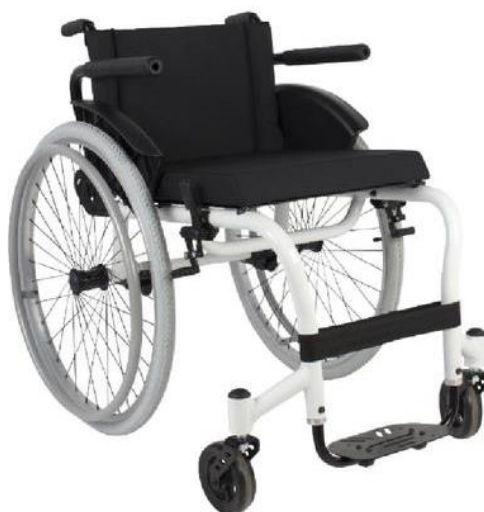
Figura 2.5 – Cadeira de rodas monobloco. (“Vollenz Reabilitação”, 2021).
