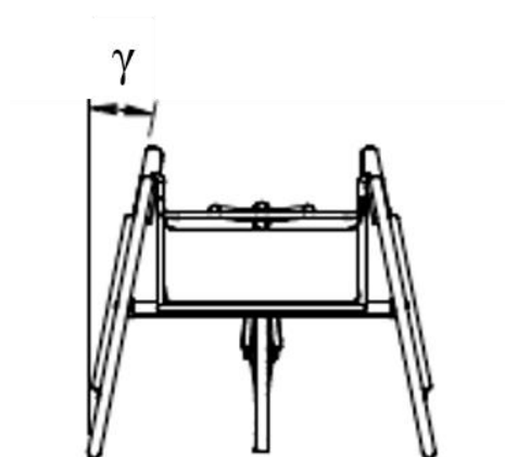
Figura 2.62 – Ângulo de cambagem negativa ( \gamma ) em cadeira de rodas. (José, 2008).
