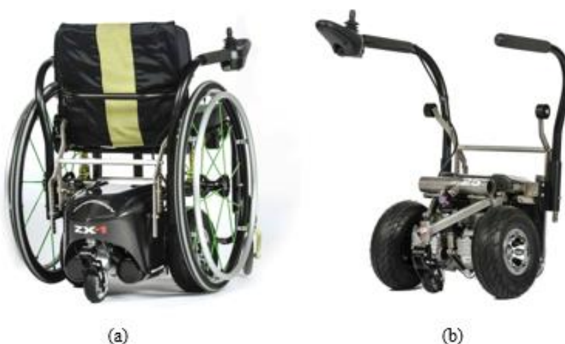
Figura 2.34 – (a) Representação do conjunto motorizado pelo RC “ ZX-1 ”, (b) módulo “ ZX-1 ”. (“Spinergy”, 2021).
