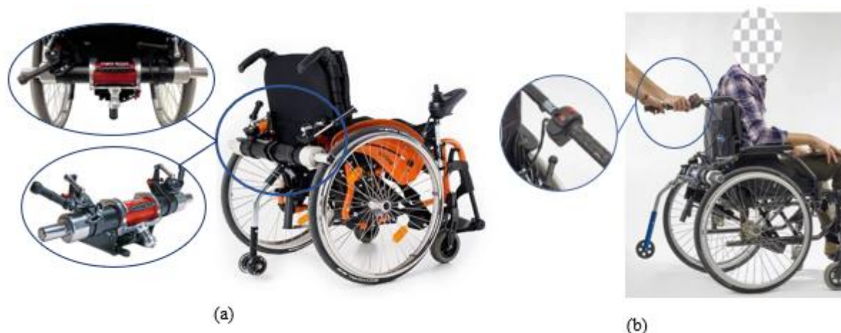
Figura 2.53 – (a) Representação do módulo “ Light Drive ”, (b) Representação do módulo “ Light Assist ”.
