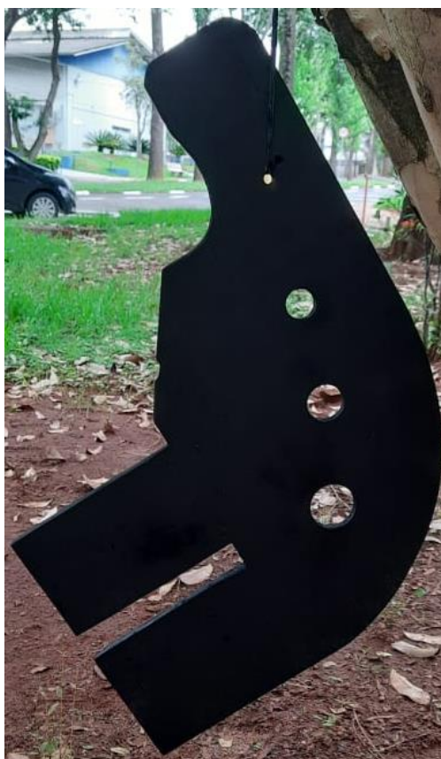
Figura 7.1 – Estrutura de suporte do kit de motorização construído em Madeira.
