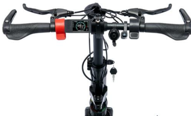
Figura 2.21 – Representação da unidade de controle do módulo “Firefly 2.5”. Adaptado (“Adaptive Specialties”, 2021).
