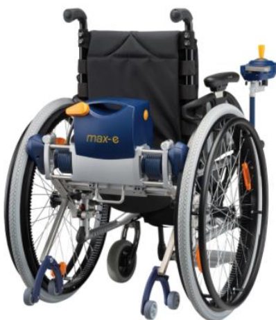
Figura 2.49 – Representação do conjunto motorizado pelo módulo “Max-e” do tipo MEA, com transmissão por engrenamento. (“AAT Asia”, 2021).
