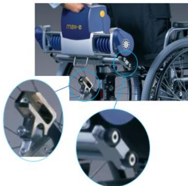
Figura 2.51 – Representação do dispositivo de engate do módulo “Max-e”. Adaptado (“Casadapta”, 2014).
