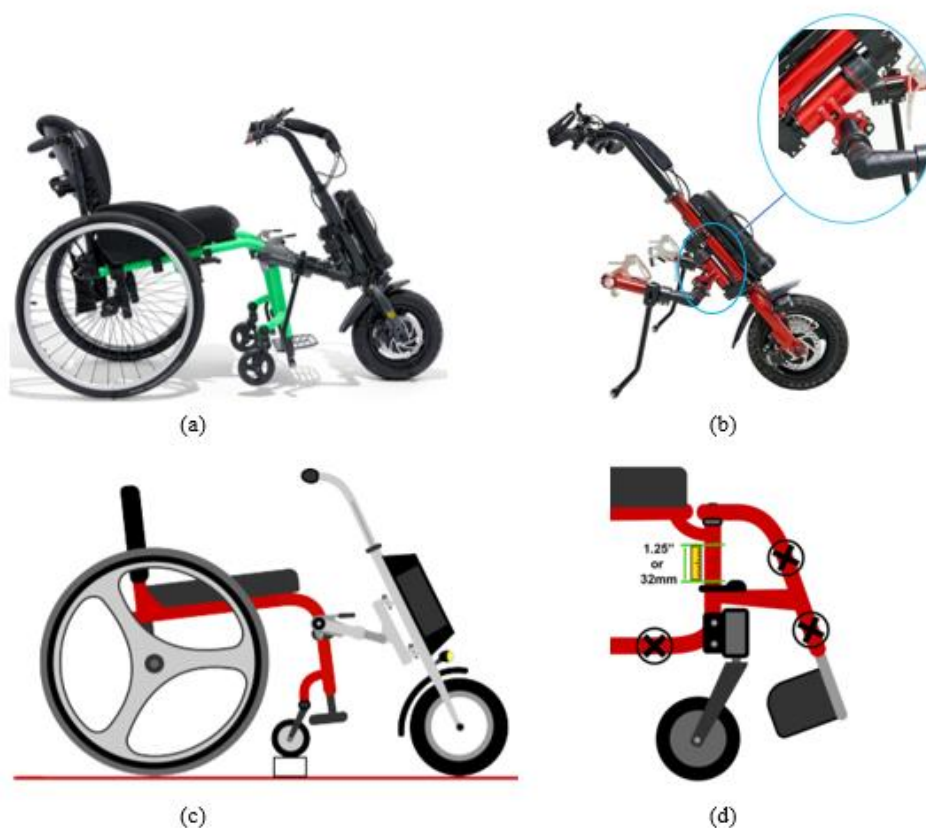
Figura 2.20 – Módulo “Firefly 2.5” e esquematização de RD. Adaptado (Mobility, 2019) e (“Adaptive Specialties”, 2021).
