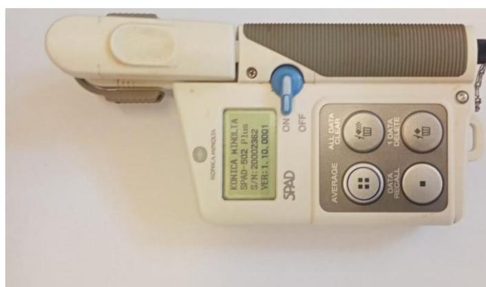
Figura 14. Medidor de clorofila SPAD 520.
