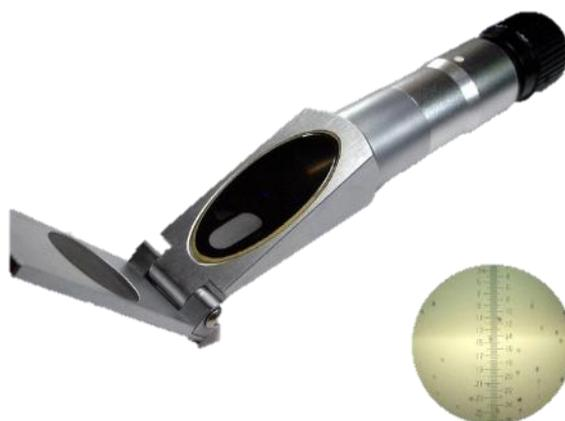
Figura 7. Refratômetro manual
