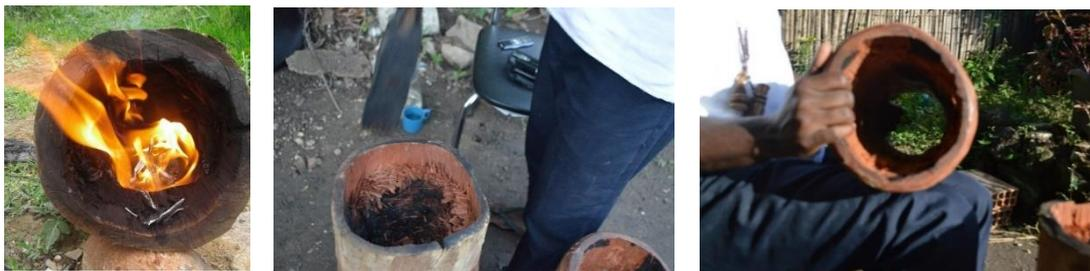
FIGURA 3.2: Escavação dos tambores - dar forma ao interno com fogo e ferro
