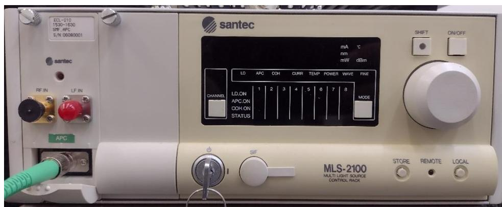
Figura 4.1 – Foto do painel frontal do laser em cavidade externa sintonizável EL-210/MLS-2100 da Santec.
