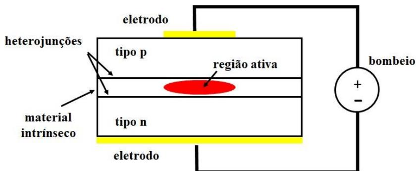
Figura 2.7 – Diagrama de um SOA convencional diretamente polarizado, destacando a formação da região ativa do dispositivo, adaptada de [22].
