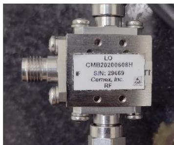
Figura 5.5 – Misturador de sinais utilizado no SCE e responsável pelo batimento entre o sinal fotodetectado e o sinal de referência para o controle.
