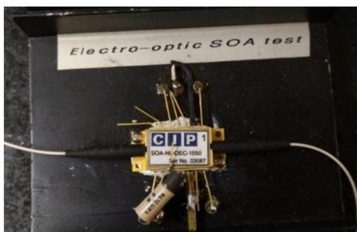
Figura 4.6 – Foto do encapsulamento que contém o SOA-NL modelo NL-OEC-1550 da CIP.
