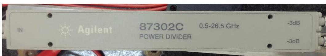
Figura 5.4 – Divisor de Potência 87302C da Agilent responsável pela amostragem do sinal do GRF para o MIXER do SCE e o MZIM do RL-OFCG.
