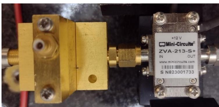
Figura 5.3 – Montagem incorporando um Bias T (à esquerda) e um amplificador de RF (à direita) utilizada no SCE proposto.
