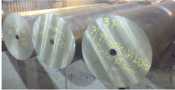
Figura 42 – Fotografia das barras na condição inicial:  $\text{Øe } 500 \times \text{Øi } 50 \times 2.000 \text{ mm}$ .
