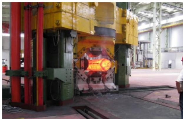
Figura 17 – Dispositivo 4DFD acoplado a prensa de 4.500 t em funcionamento. [12]
