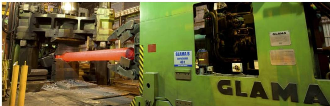
Figura 13 – Prensa hidráulica de matriz aberta de 5.000 t na empresa Villares Metals S.A. [6]
