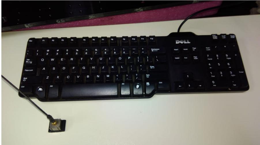
Figura 2: Teclado e acelerômetro na bancada de aquisição
