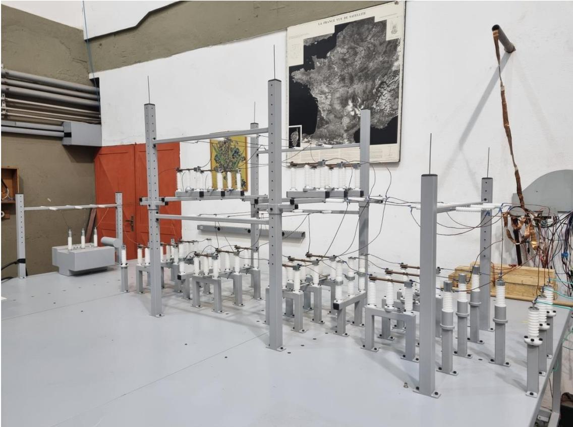
**Figura 19 –Foto da maquete com modelo reduzido da Subestação Convencional de Referência, escala 1:15 (LAT – Laboratório de Alta Tensão da Unicamp)**
