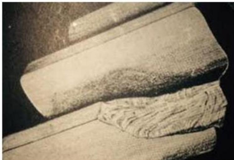
Figura 1.4. Falha por sobrecarga em dente de engrenagem. Fonte: LYNWANDER (1984).
