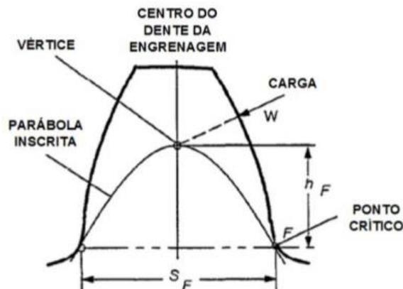
Figura 3.15. Dente de engrenagem para avaliação dos parâmetros  $s_f$  e  $h_f$ .
