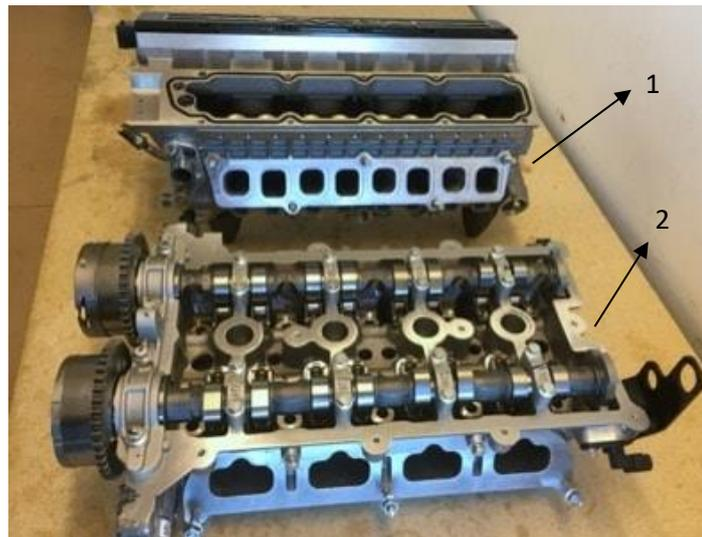
Figura 2-30. Comparativo entre os cabeçotes do Qoros 3: FreeValve =1 e convencional =2 [16].
