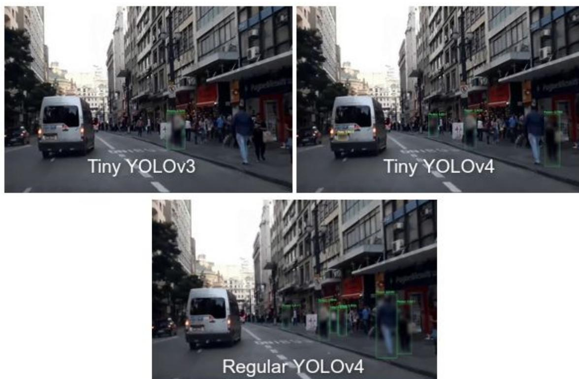
Figura 28 - Sequência 2 de frames de vídeo do trânsito de São Paulo com Tiny YOLOv3, Tiny YOLOv4 e Regular YOLOv4.
