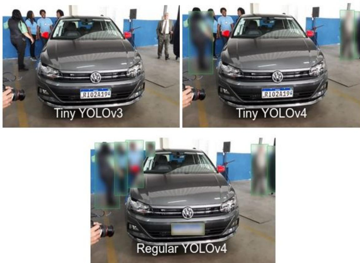
Figura 22 - Teste do Tiny YOLOv3, Tiny YOLOv4 e Regular YOLOv4 com placa da mercosul e pessoas no fundo.
