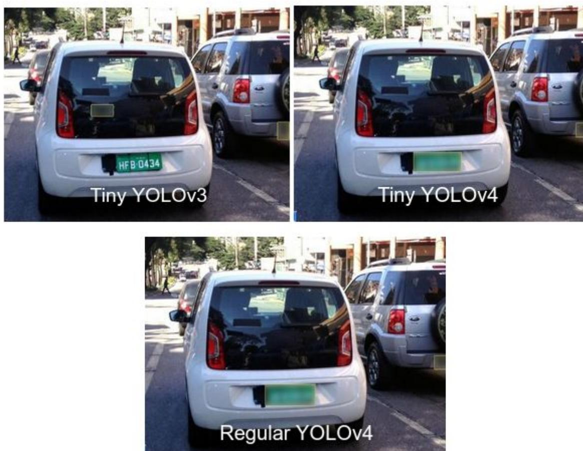
Figura 26 - Teste do Tiny YOLOv3, Tiny YOLOv4 e Regular YOLOv4 com placas de fundo verde.
