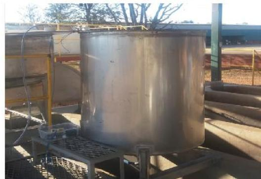
**Figura 12:** Mangueira que permite a liberação de ar do recipiente de fermentação
