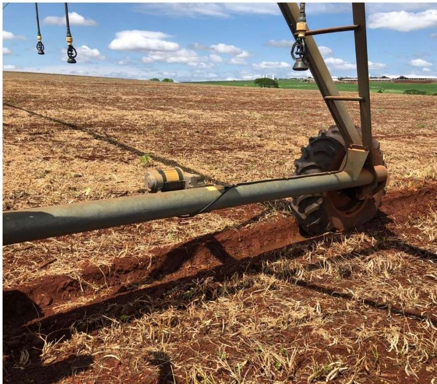
Figura 3. Motoredutor de uma torre móvel do pivô central
