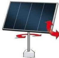
Figura 10. Sentido de rotação dos eixos para o sistema de rastreamento solar (SILVA et al, 2022).
