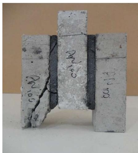
c) Ruptura no substrato em AN<sub>100</sub>
