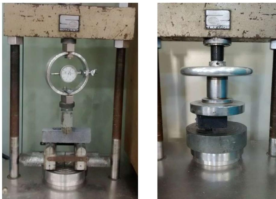
**a) Resistência à Tração na Flexão**
