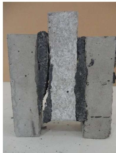
b) Tipo de ruptura das argamassas
