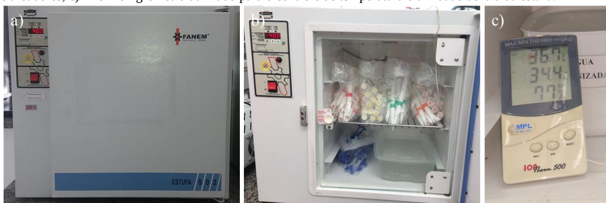
Figura 2 – Estudo da estabilidade acelerada: a) Estufa a temperatura de 40^{\circ}\text{C} ; b) Visão interna da estufa e dos géis clareadores; c) Thermohigrometro utilizado para o controle de temperatura e umidade dentro da estufa.
