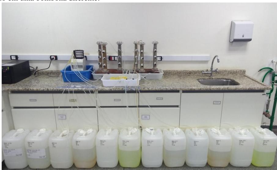
A Tabela 4.4 registra as relações entre os litotipos, fluídos, identificação das colunas e das bombonas, volume total e volume de poros lixiviados no experimento de lixiviação.
