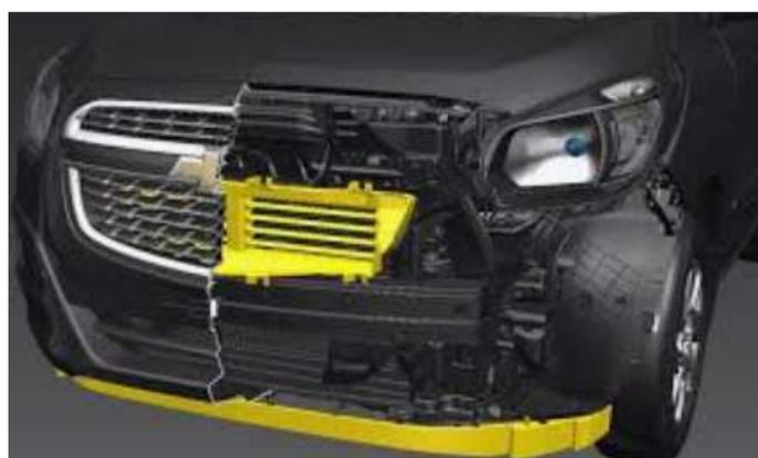
Figura 26 – Grade frontal com acionamento eletrônico (Quatro Rodas, 2016)
