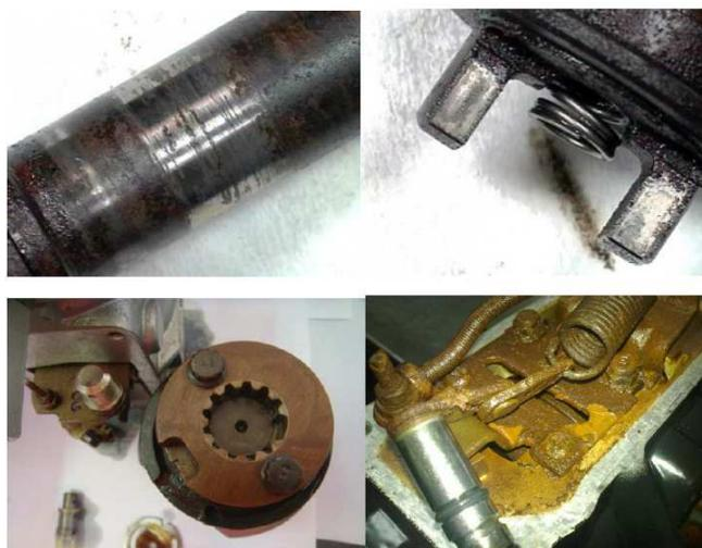
Figura 74. Componentes do sistema de injeção de um motor diesel após funcionamento com mistura de biodiesel acima de 15% (SILVA, 2019)
