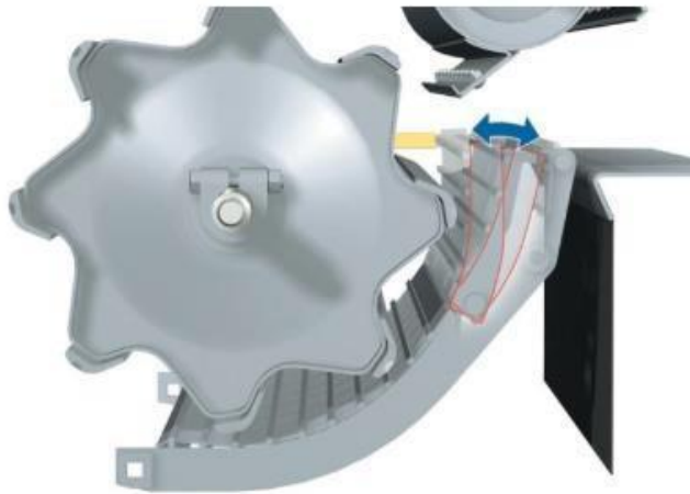
Figura 10: Exemplo de um cilindro de barras com exemplo de regulagem do côncavo. Fonte: Nunes (2016).
