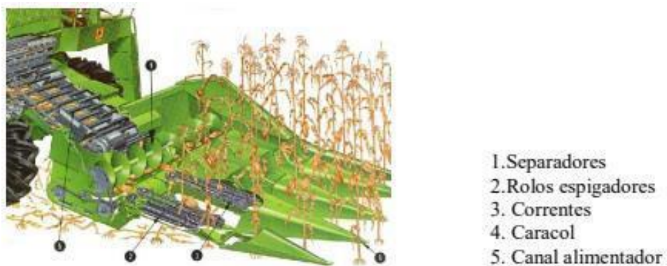
Figura 7: Plataforma de corte de milho e seus componentes. Fonte: John Deere.
