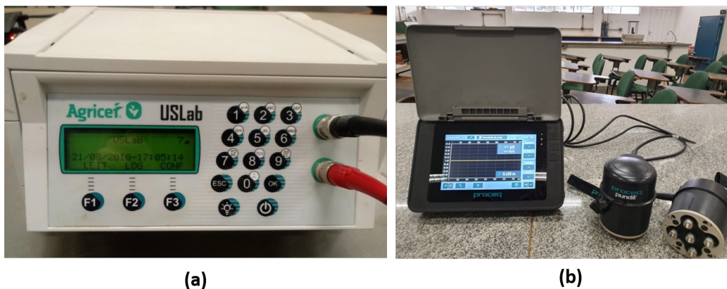
Figura 3.2: Equipamentos de ultrassom (a) UsLab e (b) Pundit
