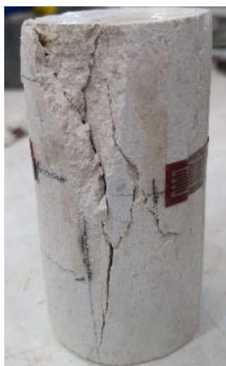
Figura 7. Rocha fragmentada após o ensaio de compressão estática.
