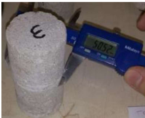
Figura 5. Cilindro utilizado no ensaio de compressão.
