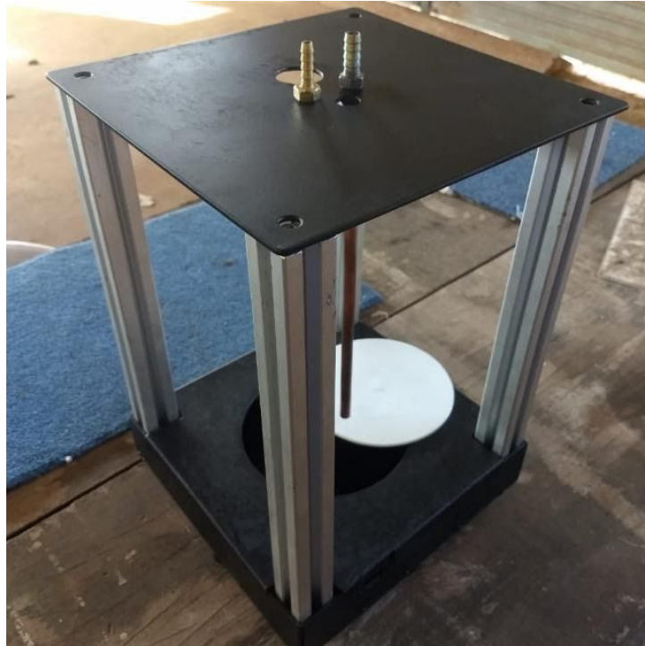
Figura 2: Fluxômetro de massa feito em oficina e utilizado nos testes.
