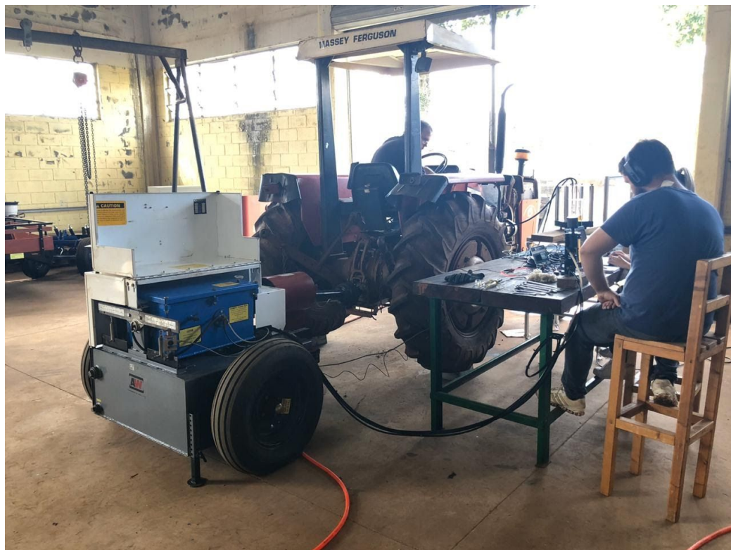
Figura 1: Foto do dinamômetro acoplado à TDP do trator MF265.
