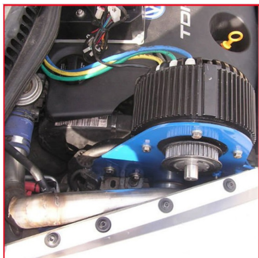
(a) Motor elétrico de kit de hibridização em série
