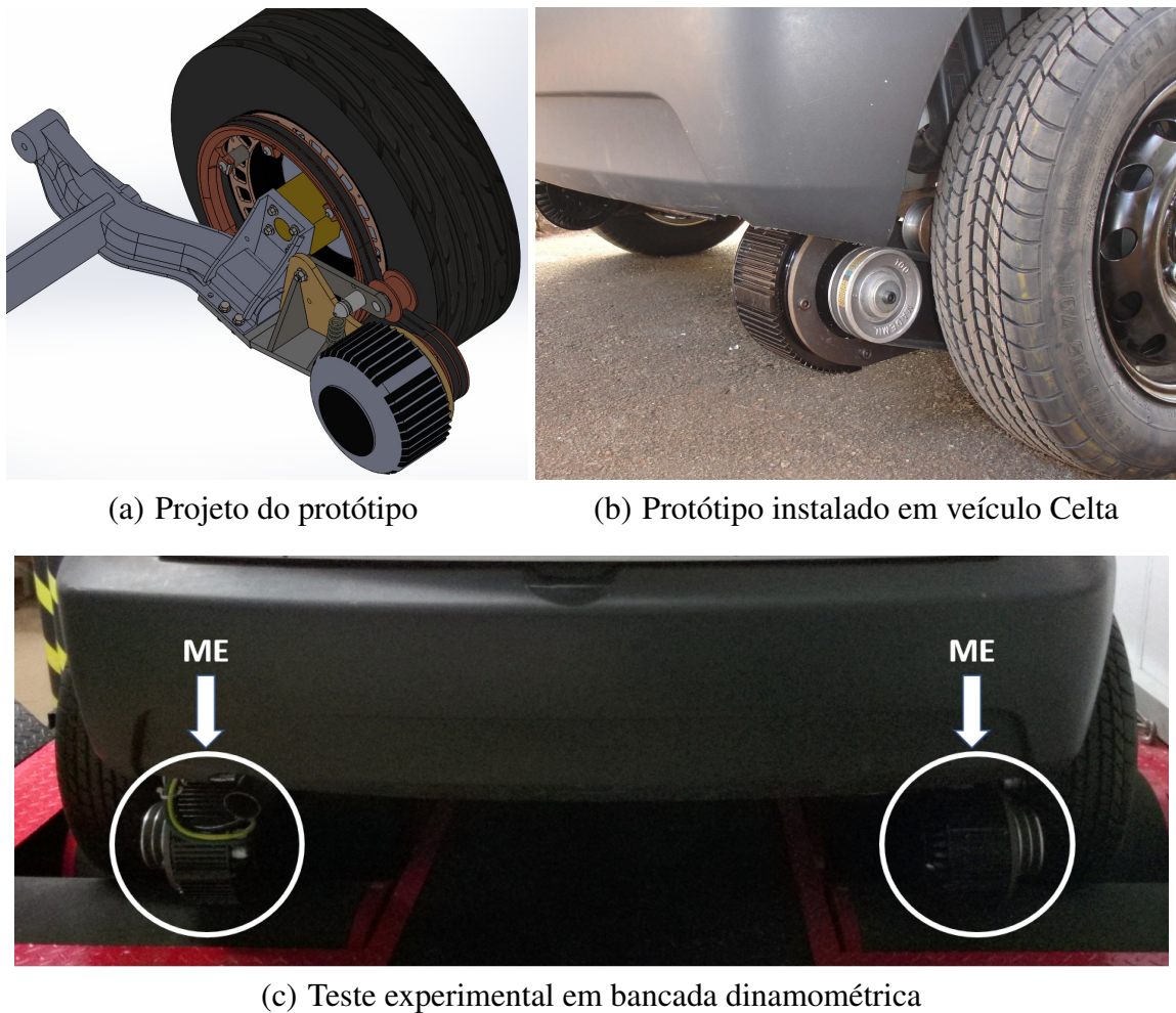
Figura 1.2: Sistema de motorização auxiliar desenvolvido no Projeto Roda Elétrica
