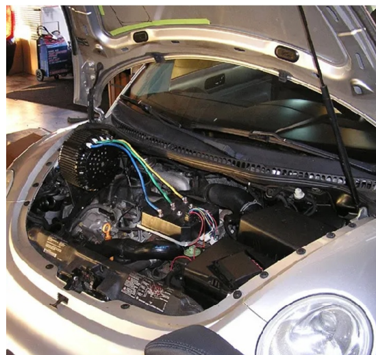
(b) Módulo de conversão híbrida instalado em veículo convencional
