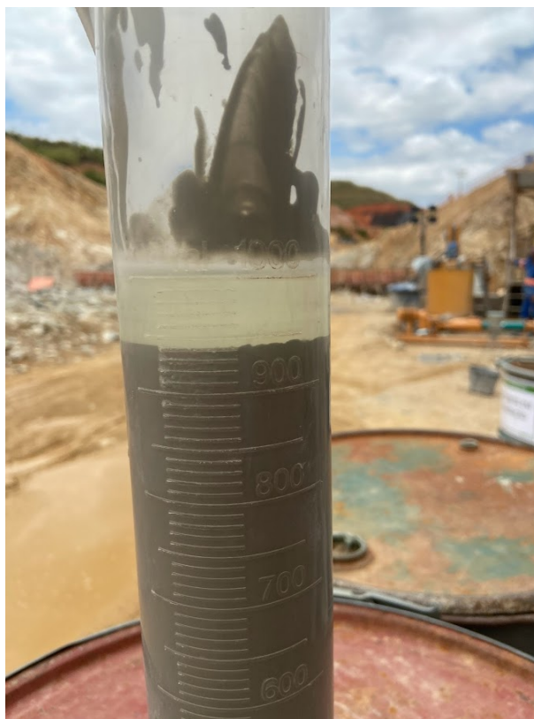
Figura 8 – Foto do resultado de um ensaio de sedimentação da calda de cimento. Fonte: Acervo pessoal.
