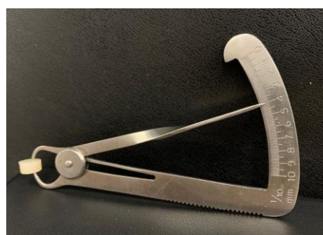
Figura 6. Checagem das dimensões da amostra com espécímetro
