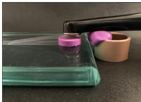
Figura 4. Fotopolimerização das amostras
