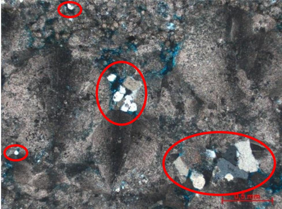
Figura 33. Lâmina delgada de Spherulitstone com pequenas amostras de Dolomita (círculos vermelhos).
