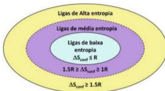
**Figura 2.8** Tipos de ligas baseado em sua entropia configuracional (GAO *et al.*, 2016)
