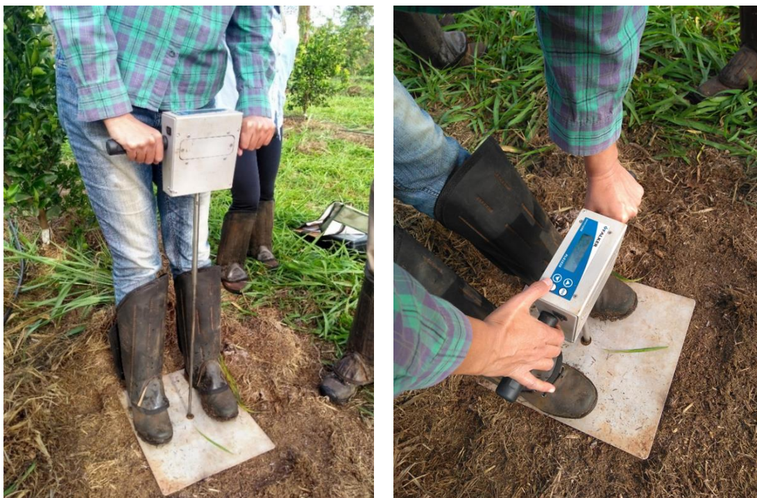
Figura 11. Medidor eletrônico de compactação do solo em Sistema Agroflorestal de citros sob diferentes densidades arbóreas, em Itirapina, São Paulo, Brasil.
