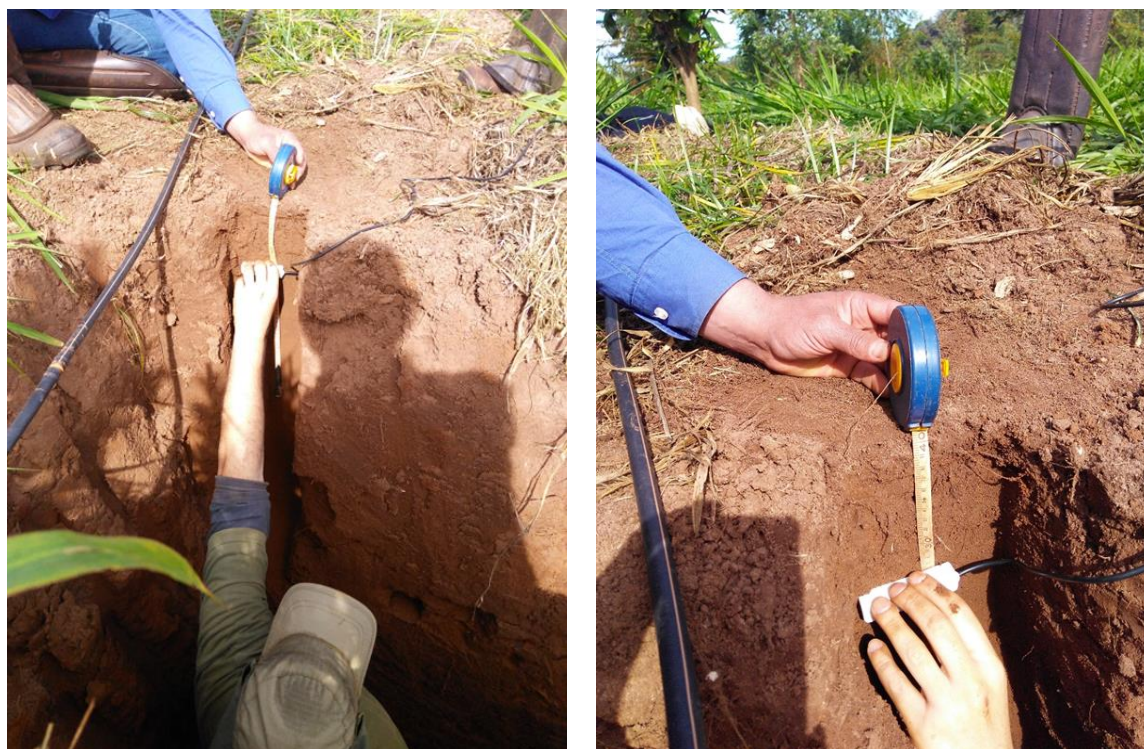
Figura 10. Sensor de umidade em Sistema Agroflorestal de citros sob diferentes densidades arbóreas, em Itirapina, São Paulo, Brasil.
