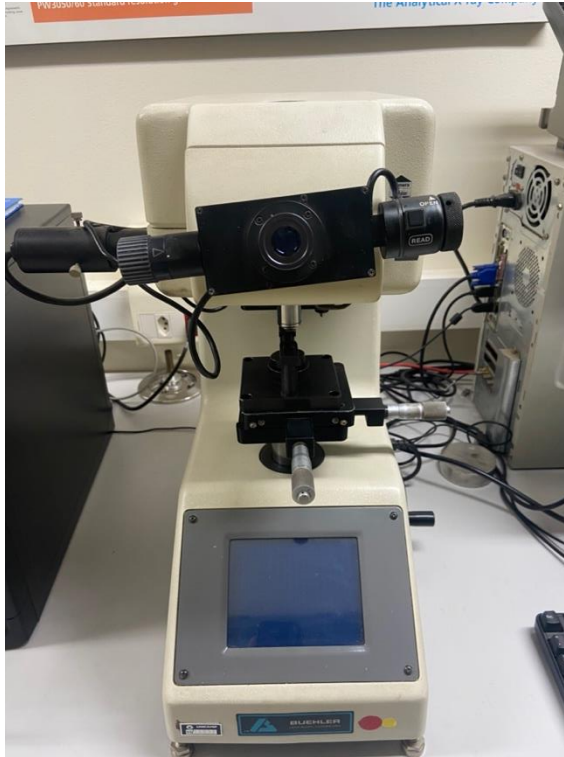
Figura 3.9 – Durômetro Vickers Buehler modelo 2100 (a) e equipamentos de medição do módulo de elasticidade por técnicas acústicas (b) (LABMET– Faculdade de Engenharia Mecânica da UNICAMP).
