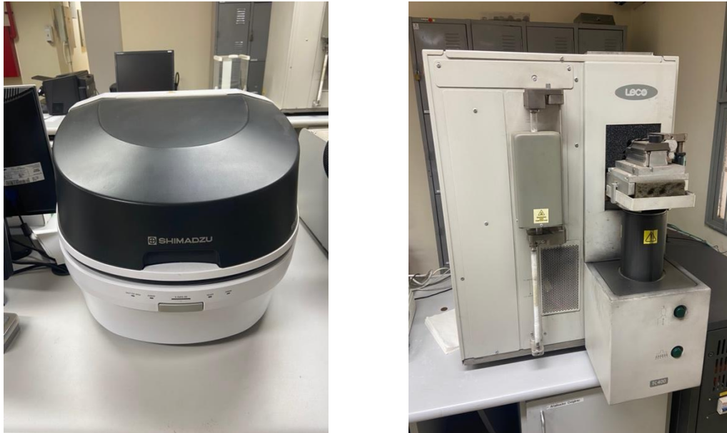
Figura 3.5 – Equipamento de FRX Shimadzu EDX-7000 (a) e de análise de O e N Leco TC400 (b) utilizados na caracterização da composição química das amostras (LABMET– Faculdade de Engenharia Mecânica da UNICAMP).
