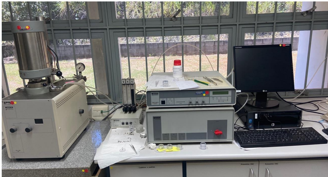
Figura 3.8 – Equipamento de análise térmica simultânea Netzsch STA 409C (LABMET– Faculdade de Engenharia Mecânica da UNICAMP).
