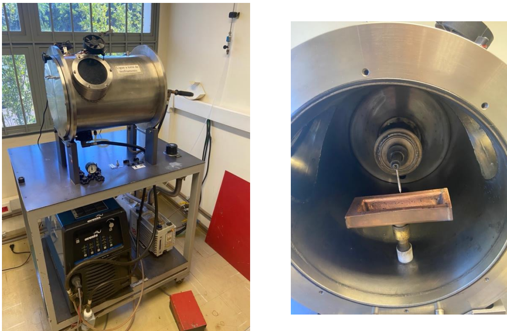
Figura 3.3 – Forno a arco voltaico utilizado na produção das ligas (LABMET– Faculdade de Engenharia Mecânica da UNICAMP).
