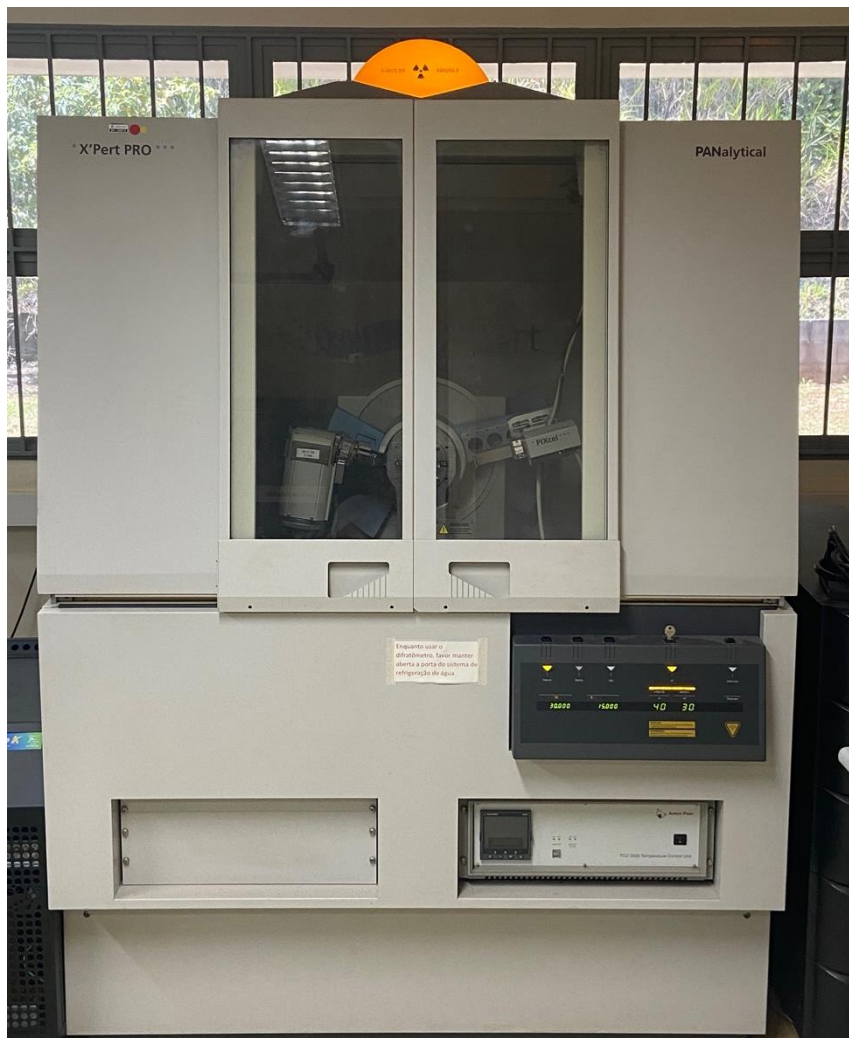
Figura 3.7 – Difratorômetro de raios-X Panalytical modelo X'pert PRO equipado com detector PIXcel (LABMET– Faculdade de Engenharia Mecânica da UNICAMP).
