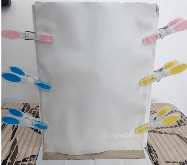
**Figura 7. Fotografia: Célula Al-Aço.** Fotografia da célula Al-Aço composta por uma placa alumínio e outra de aço inoxidável. Papel filtro foi colocado em cada face voltada para o ambiente e outras duas folhas foram colocadas entre os metais.
