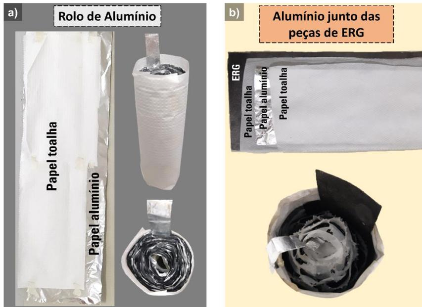
**Figura 11. Fotografias da configuração de alumínio empregada no aumento de área.** a) Fotografias do material usado para montar o rolo de alumínio com fotografias do rolo. b) Fotografias do material usado para montar as células com o alumínio em contato com as peças de ERG e fotografia do rolo de ERG/papel toalha/Al dentro de uma lata.
