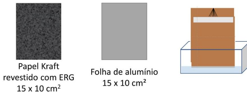
**Figura 36. Representação esquemática da célula ERGK-AI.P.**
