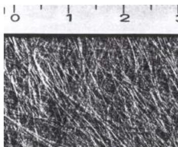
c. Geotêxtil não tecido ligado termicamente
