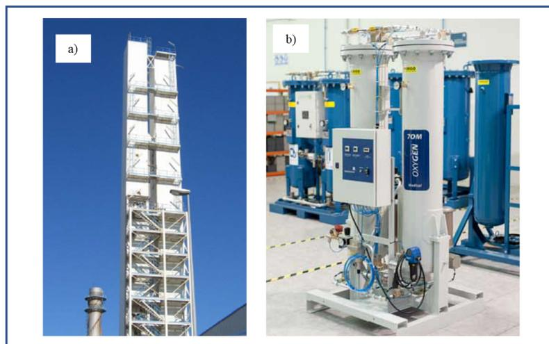
Figura 2.4: a) Unidade de destilação criogênica de ar atmosférico liquefeito, Michell Instruments, e b) unidade PSA para produção de corrente enriquecida de  $O_2$  da Empresa SYSADVANCE.
