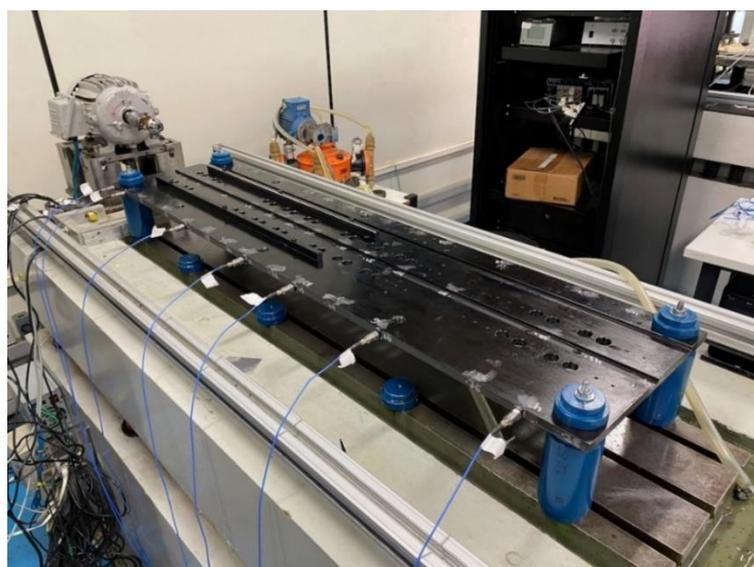
Figura 17 – Base montada na fundação.
