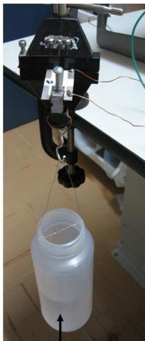
Frasco com água correspondente à carga (gF)
