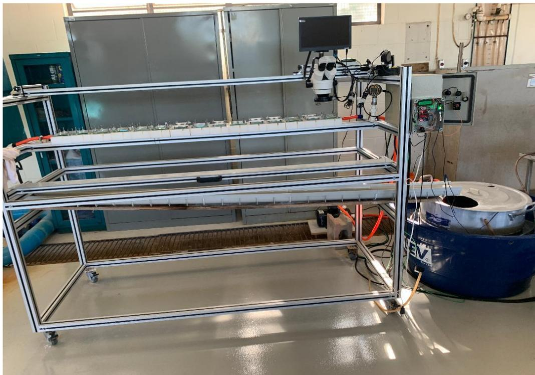
**Figura 10.** Bancada de ensaios com os protótipos de gotejador acoplados aos suportes, câmera para aquisição de imagens e reservatórios.
