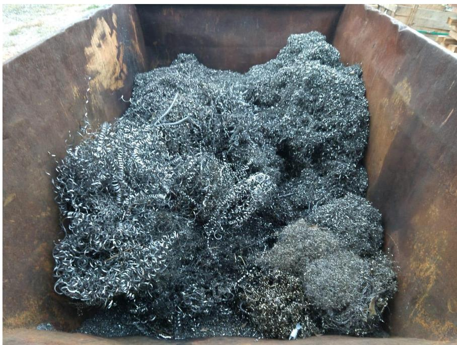
**Figura 1-** Caçamba de cavaco de aço carbono
