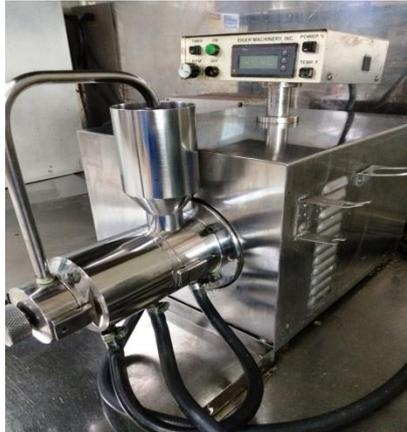
**Figura 1.6** – Moinho horizontal de esferas de laboratório (Fonte própria)
