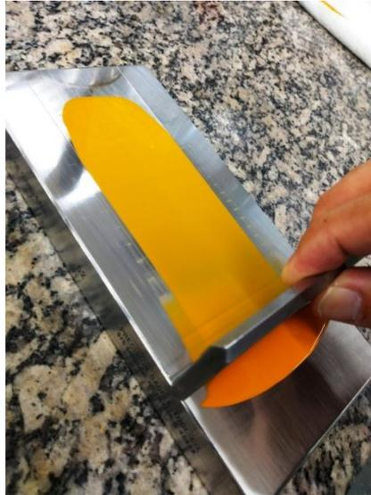
**Figura 1.7**– Medidor de fineza Hegman (Fonte própria)
