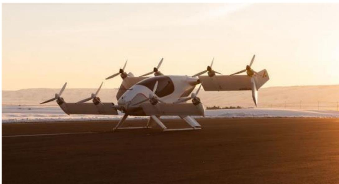
Figura 4 - O protótipo de tamanho real “*Alpha One*” já acumulou mais de 138 voos de teste em escala real no ano de 2019, sendo a maior duração de voo de 20 minutos.
