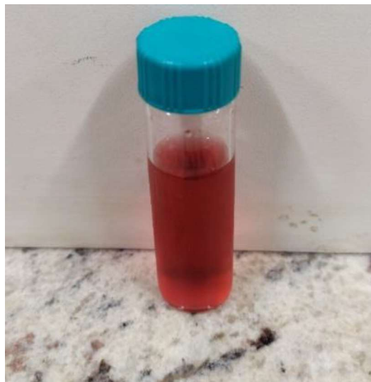
Figura 6. AuNPs sintetizadas através do método experimental proposto por Ratnarathorn et al. [84]
