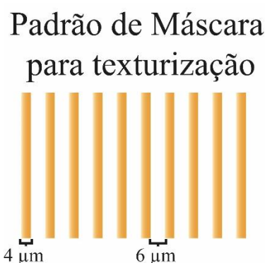
Fig. 3.4: padrão de linhas paralelas com 4 \mu\text{m} de largura, espaçadas 6 \mu\text{m} entre si, da máscara de cromo de campo claro, utilizada para a texturização das estruturas de V-groove, pirâmides verticais e pirâmides invertidas na superfície do c-Si.
