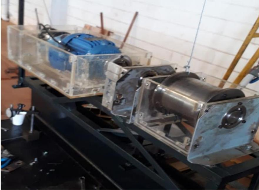
Figura 25 – lateral da bancada de teste vista pela célula de carga reativa e motor elétrico
