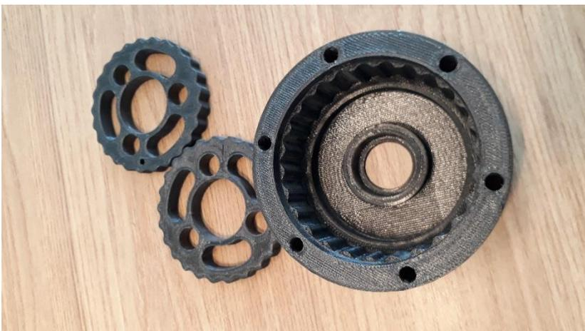
Figura 11 – Modelo do redutor planetário impresso em 3D
