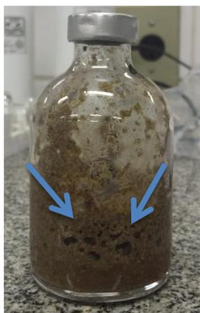
Figura 8: Biogás produzido após 24 h.
