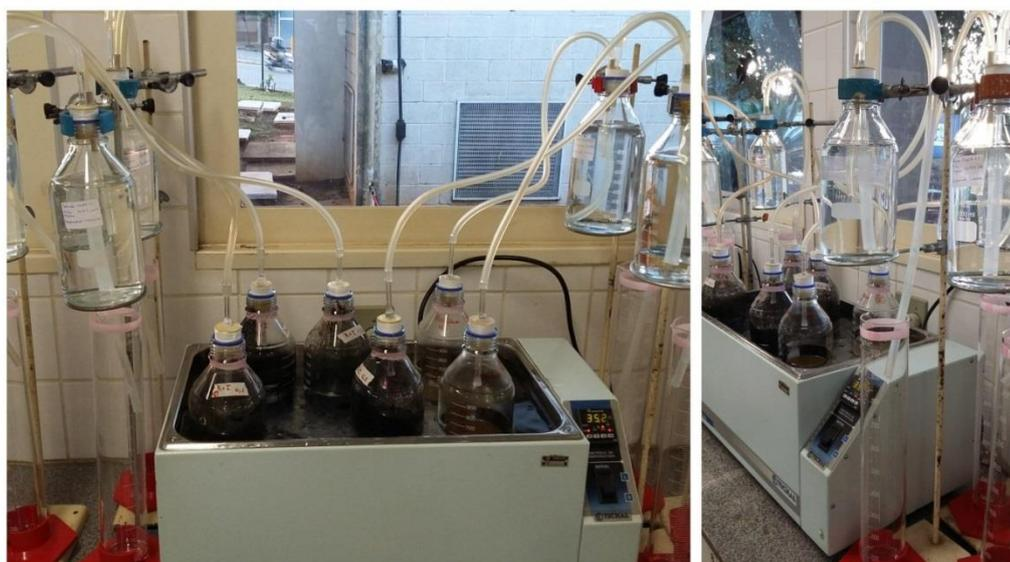
Figura 10 – Aparato do teste de AME.
