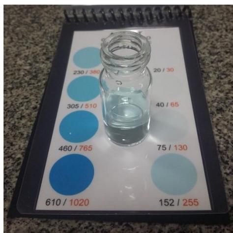
Figura 3: Cartela colorimétrica para determinação de gás sulfídrico ( $\text{H}_2\text{S}$ ).
