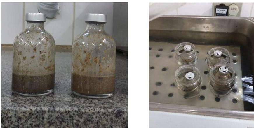
Figura 7: Biodigestores preparados e inseridos em banho maria.
