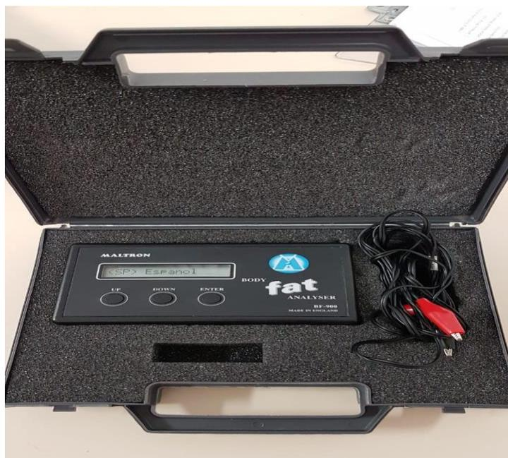
**Figura 1** - Imagem do aparelho utilizado de Bioimpedância Elétrica - *Maltron BF-906*
