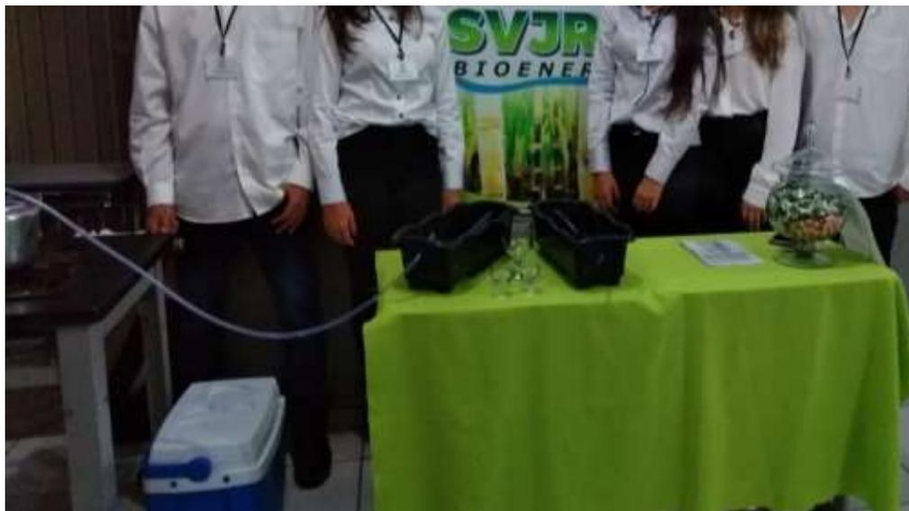
Esse grupo elaborou sua apresentação com base em dois momentos: exposição teórica e produção do etanol. Através de um mecanismo de destilação adaptado os estudantes demonstraram a produção prática do etanol de 1ª geração através do caldo de cana e do suco de beterraba. Para isso, utilizaram uma panela de pressão (aquecimento dos sucos), uma mangueira condutora, banho de gelo (condensação) e um copo medidor (recolhimento do material).
