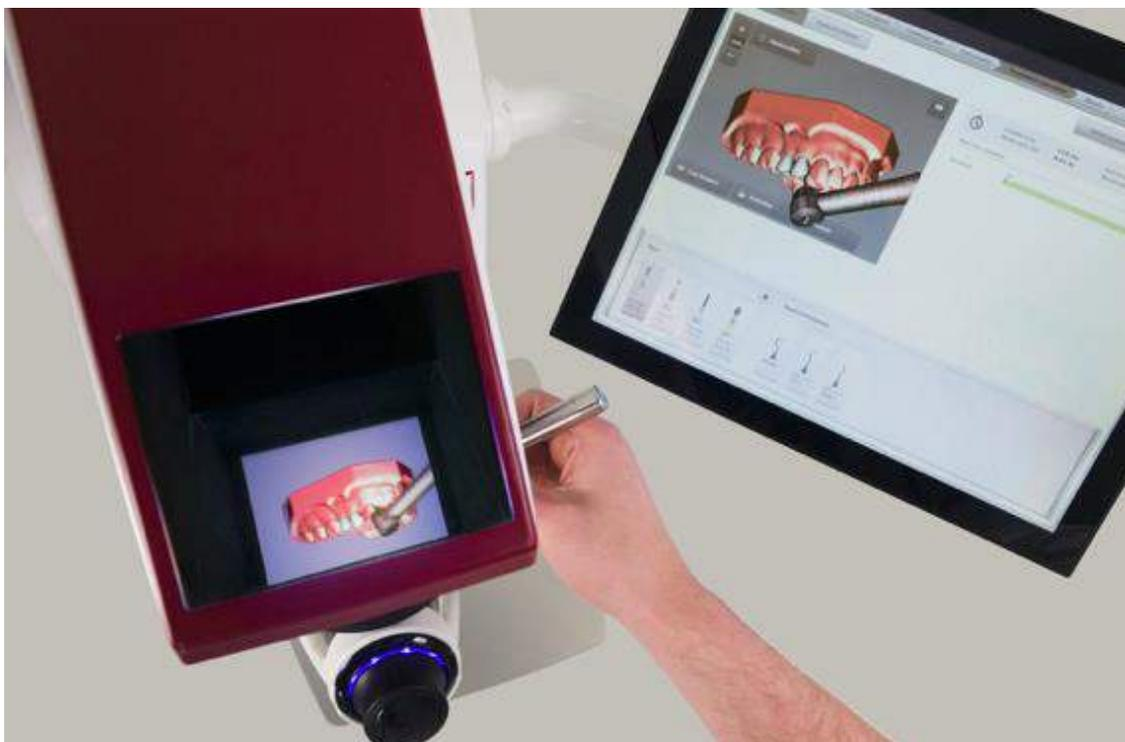
Figura 1: Moog Simodont Dental Trainer - Visualizador de exibição 3D, com material didático exposto em tela; Painel PC reproduzindo o exposto no visualizador de exibição.
