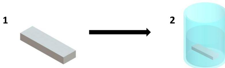
Figura 2 - Espécime de material após a fotoativação na matriz (1), seguido de sua inserção em recipiente contendo água deionizada (2)
