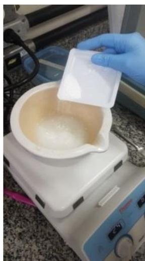
Figura 4 - Pulverização da fase 2 sob agitação moderada.
