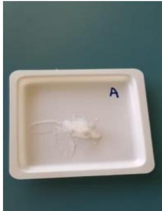
Figura 7 - Um grama de gel para a aplicação em um dos segmentos.
