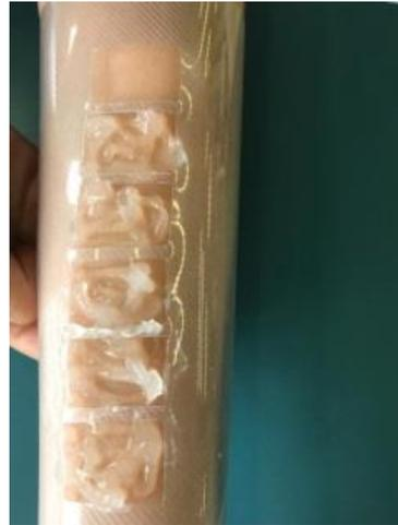
Figura 8 - Aplicação do gel em 5 segmentos.
