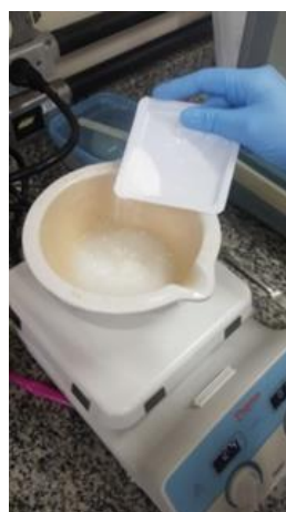
Figura 4 – pulverização da fase 2 sob agitação moderada.
