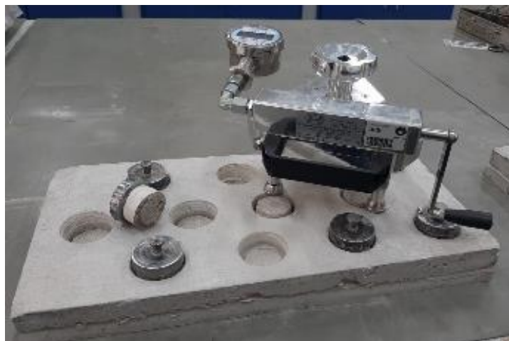
Figura 26: Realização do ensaio de arrancamento, com posicionamento do dinamômetro de arrancamento.
