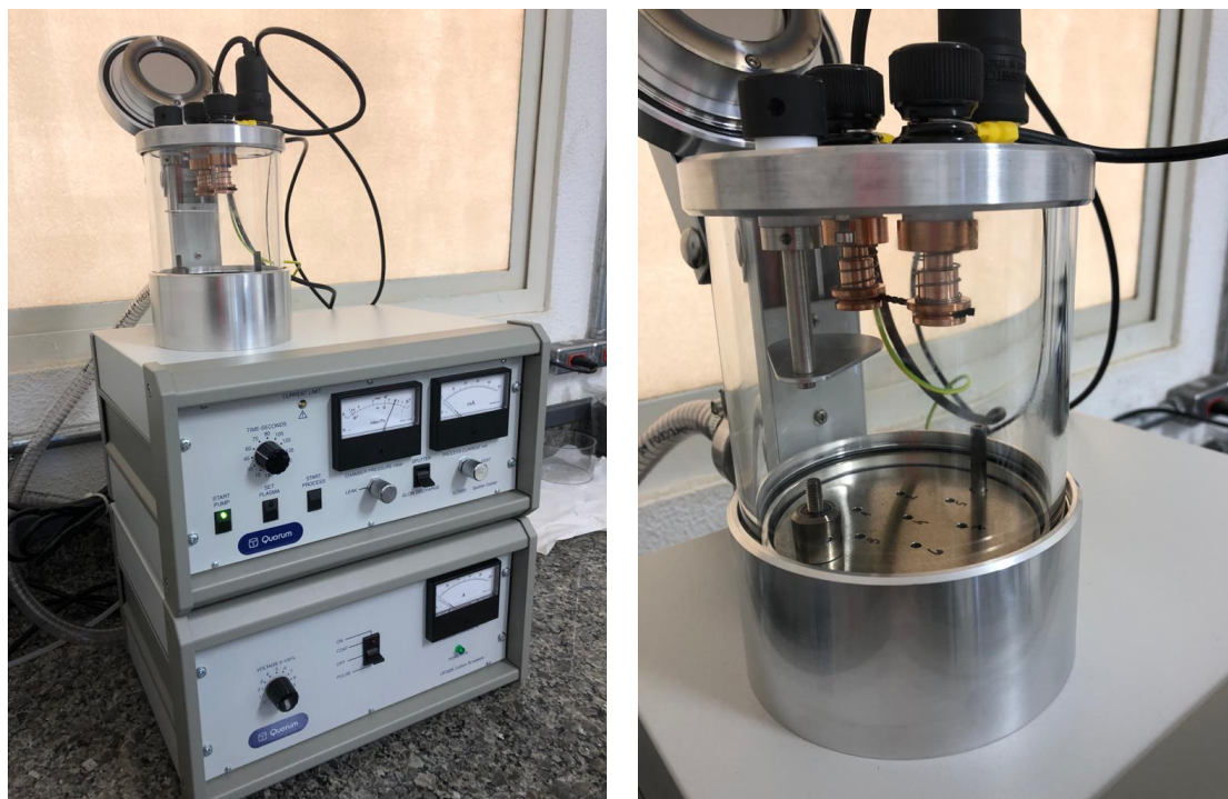
Figura 30: a) Metalizadora preparada para utilizar carbono para cobertura das amostras
