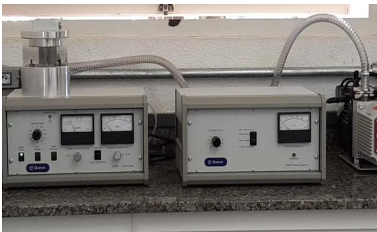
Figura29: a) Metalizadora preparada para utilizar platina para cobertura das amostras
