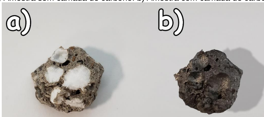
Figura 12 - Amostra antes e depois da metalização com carbono. a) Amostra sem camada de carbono. b) Amostra com camada de carbono
