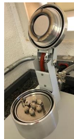
Figura29: a) Metalizadora preparada para utilizar platina para cobertura das amostras
