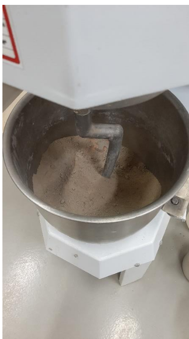
Figura 16: Mistura dos materiais secos na argamassadeira
